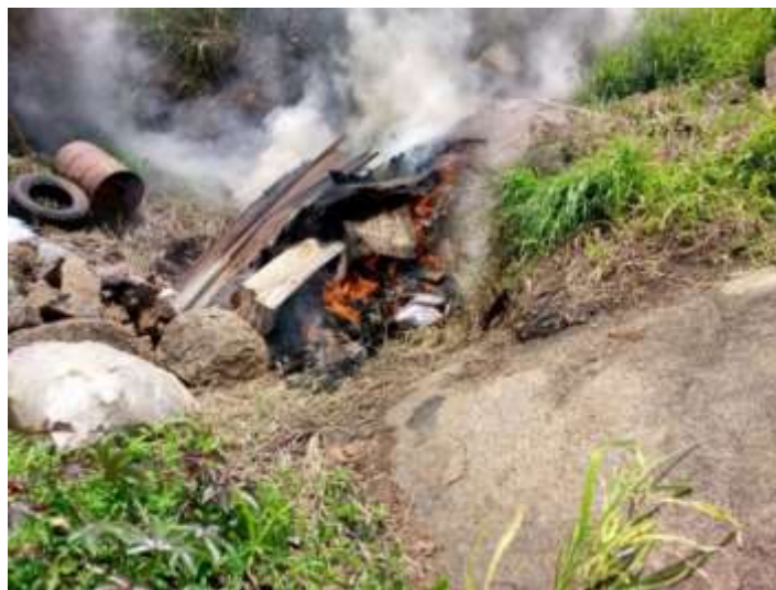
Photo 1 : Pratique de la transformation de la roche en graviers
